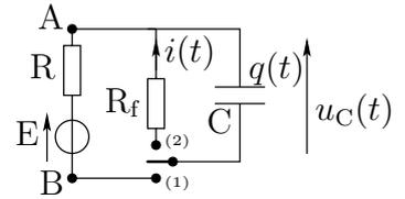
Lorsque l'interrupteur est en position (1), le générateur assure la charge du condensateur qui atteint une charge proche de sa charge maximale  $q_0$ . À  $t = 0$ , l'interrupteur est basculé en position (2), le condensateur se décharge dans  $R_f$ , ce qui provoque un éclair lumineux.
