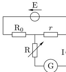
1. Exprimer l'intensité  $I$  traversant le galvanomètre en fonction de  $E$ ,  $R_0$ ,  $r$ ,  $R$  et  $g$ . Examiner le cas où l'on confond  $R_0 + r$  avec  $R_0$ .
