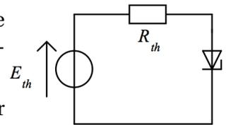
**18. Stabilisation de tension par diode Zener\*\*\*** Un générateur peut être modélisé comme une source idéale de tension  $E = 10 \text{ V}$  en série avec une résistance  $r = 50 \Omega$ .
