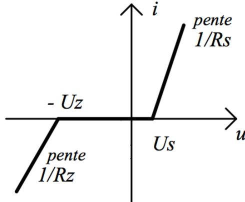
**Données :**  $R_1 = 11 \Omega$ ;  $R_2 = 11 \Omega$ ;  $R_3 = 20 \Omega$ ;  $I_{02} = 0,80 \text{ A}$ ;  $U_s = 0,80 \text{ V}$ ;  $R_s = 1,2 \Omega$ ;  $U_z = 2,7 \text{ V}$ ;  $R_z = 4,8 \Omega$ .
