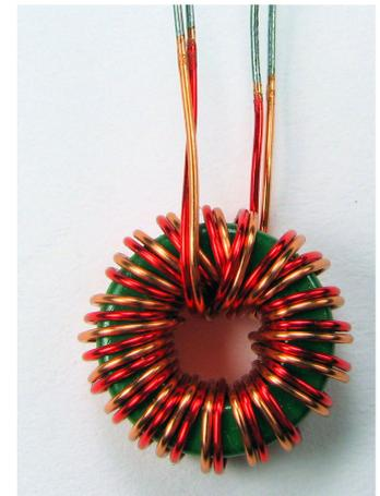
FIGURE 5.5 – À gauche : modélisation du transformateur en tant qu'enroulements primaire et secondaire placés autour d'un matériaux ferromagnétique qui guide parfaitement les lignes de champ de l'un à l'autre. À droite : réalisation pratique d'un tel transformateur, les deux enroulements ont chacun leur couleur propre.
