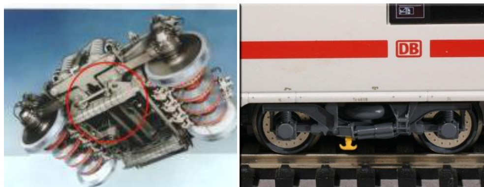
Figure 4.5 – Système de freinage à induction présent dans les wagons de la Deutsche Bahn.
