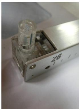
Figure 1.2 – Capteur à effet Hall. Seule la composante orthogonale à la place semi-conductrice peut être mesurée : il faut donc toujours vérifier l'orientation du « bitonniau » orientable à l'avant du capteur.
